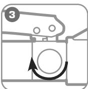
**Поверните винт сброса давления в положение «Закрыть»**
