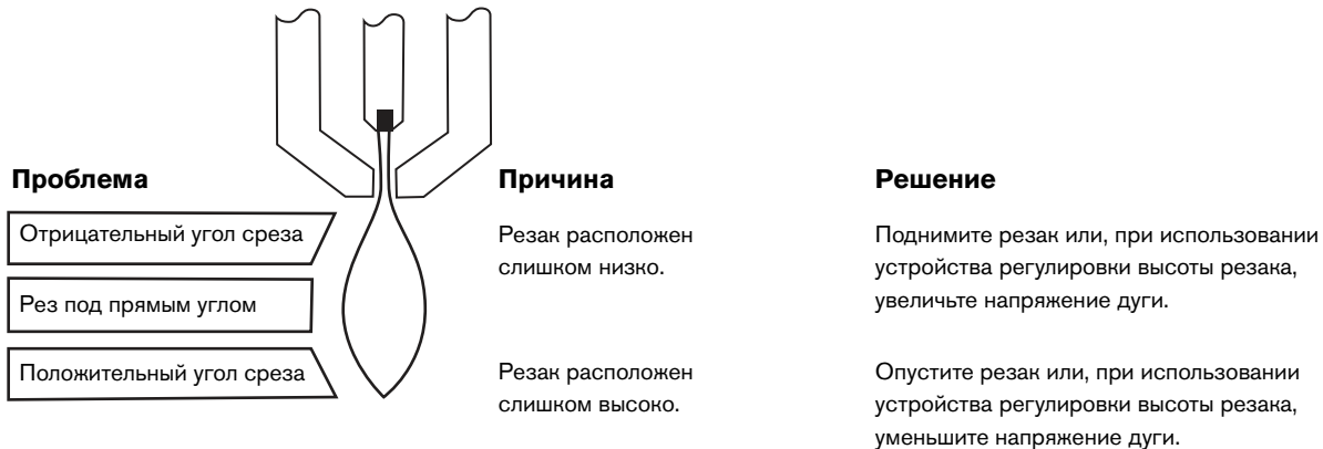
Рисунок 4 – Углы среза
